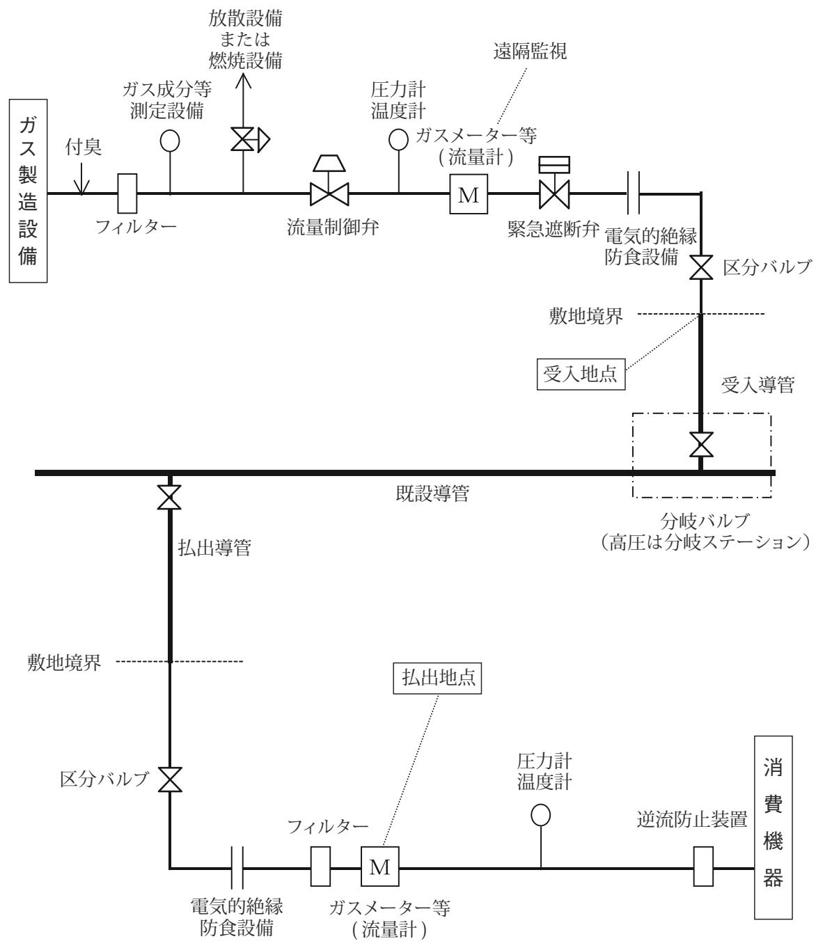
(注) 上図は概念図として参考に図示したものです。ガス製造形態や受入および払出地点の位置等による差異が大きいため、詳細は個別に協議させていただきます。
